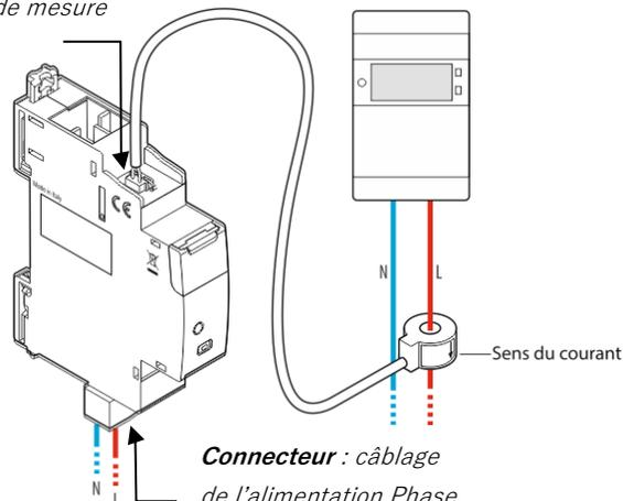
Connecteur : câblage de l'alimentation Phase (V1) et Neutre (N)
